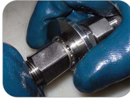
Avec le manchon rétracté, retirer le raccord mâle (nipple)
