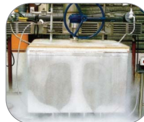
Banc d'essai cryogénique à -320°F
